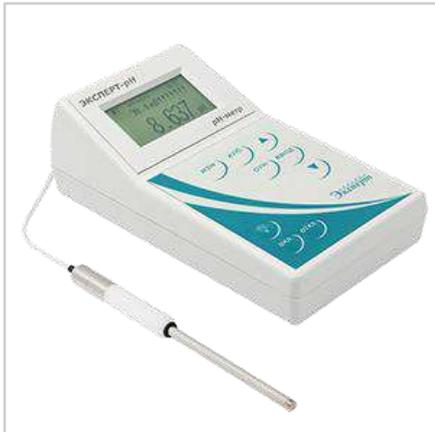
Интеллектуальный pH-метр нового поколения (без электродной системы) Эксперт-pH предназначен для создания на его основе гибких комплекций с разнообразными электродами под индивидуальные требования заказчика и измерения температуры.
