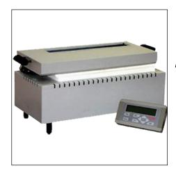
быстродействующая лабораторная Компактная одновременного выпаривания и озоления не менее 18 проб различных объектов.
