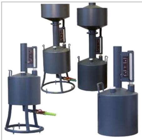
Мерники эталонные 2 - го разряда с шифром «01» и «01П» предназначены для поверки технических мерников 2 класса, измерительных резервуаров, топливораздаточных колонок, дозаторов бензина и дизельного топлива, спирта и других жидкостей, позволяющих измерить дозу рабочей жидкости при температуре +20°С в объеме полной вместимости.
