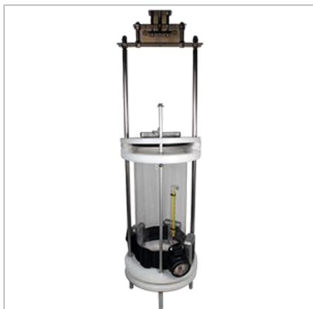
Батометр Руттнера предназначен для отбора водных проб с заданной глубины водоема при проведении экологических, гидрологических, океанографических и других работ.
