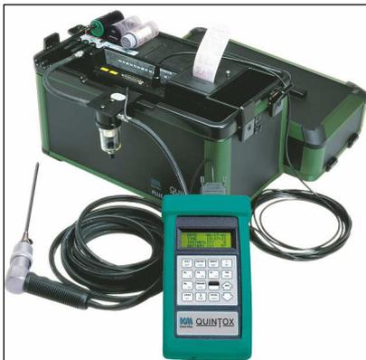
KM9106 Quintox газоанализатор переносной электронный с автономным питанием позволяет проверить, оперативно настроить и обслужить котлы, печи, газовые турбины, горелки, дизельные установки, работающие на любом виде топлива, а также контролировать выбросы углеводородов, азота, серы, оксидов углерода.
