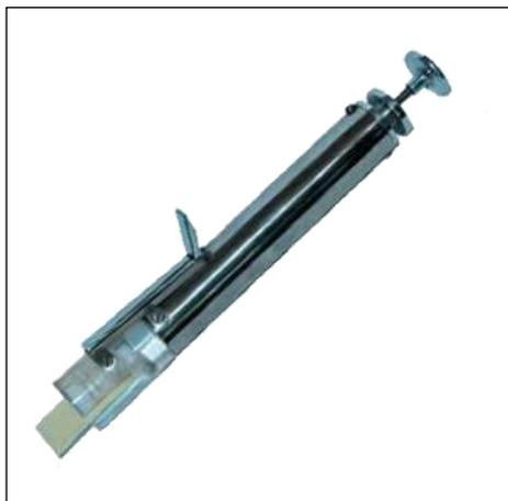
ПОЗ-Т предназначен для определения свободной воды и механических примесей в топливе (авиационный бензин, авиационный керосин с присадками и без них).
