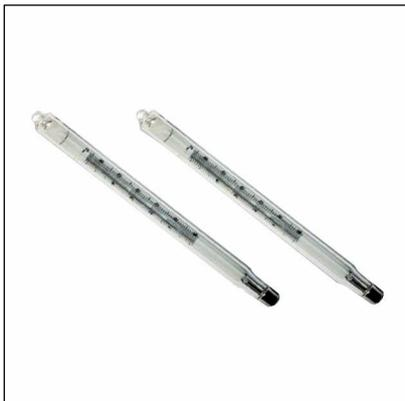
Термометр лабораторный ТЛС-6 предназначен для измерения температуры в интервале от -30 до 360°C в процессе лабораторных исследований.
