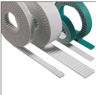
Зубчатые ремни **ALPHA linear** в рулонах (в погонных метрах) предназначены преимущественно для применения в линейных приводах. Корды из стали и арамида являются чрезвычайно малорастяжимыми. Термопластический полиуретан идеально подходит для нанесения различных покрытий. Также возможно наваривание захватов.
