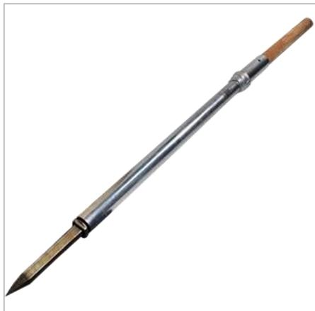
Пешня трёхгранная предназначена для рубки лунок во льду при проведении гидрологических работ, по измерению толщины льда, во время ледостава на реках и водоёмах. Изготавливается из закалённой стали и твёрдых пород дерева.
