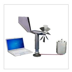
Метеостанция M-49M c компьютерным метеоадаптером (пультом без цифровой индикации) предназначена для дистанционного измерения скорости и направления ветра, атмосферного давления, температуры и относительной влажности воздуха, выдачи и сохранения результатов измерения на компьютер через интерфейс RS-232.
