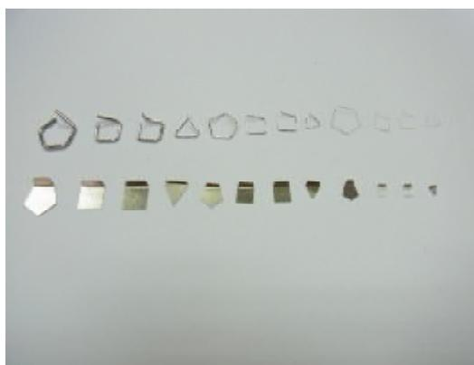
Рис. 3. Гири миллиграммовые пластинчатые и проволочные
