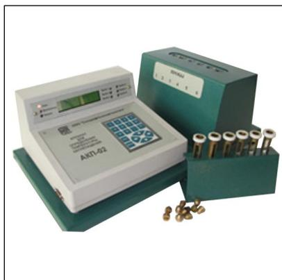
Аппарат автоматический универсальный **АКП-02У** предназначен для определения температуры каплепадения нефтепродуктов - температуры, при которой происходит падение первой капли нефтепродукта при нагревании.
