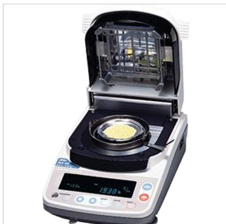
Универсальный анализатор влажности МХ-50 для определения влагосодержания в твердых, жидких и парообразных материалах максимальным весом образца 51 гр. методом нагрева, что позволяет получить точный результат с помощью 20 автоматических программ измерения с погрешностью до 0.01% влажности.
