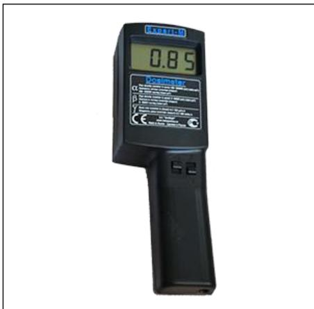
Дозиметр-радиометр Эксперт-М предназначен для измерения мощности амбиентного эквивалента дозы фотонного (рентгеновского и гамма-) излучения, для измерения плотности потока бета-частиц и для оценки плотности потока альфа-частиц от загрязненных поверхностей.
