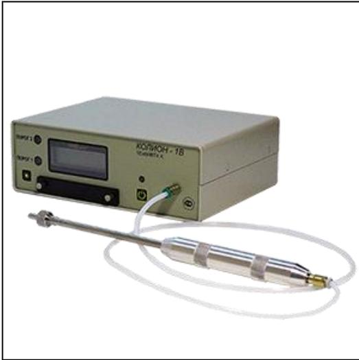
Газоанализаторы переносные многодетекторные КОЛИОН-1В предназначены для одновременного измерения дозврывоопасных концентраций углеводородов, начиная с метана, и их концентраций на уровне ПДК воздуха рабочей зоны, а также для селективного измерения оксида углерода; сероводорода и кислорода.
