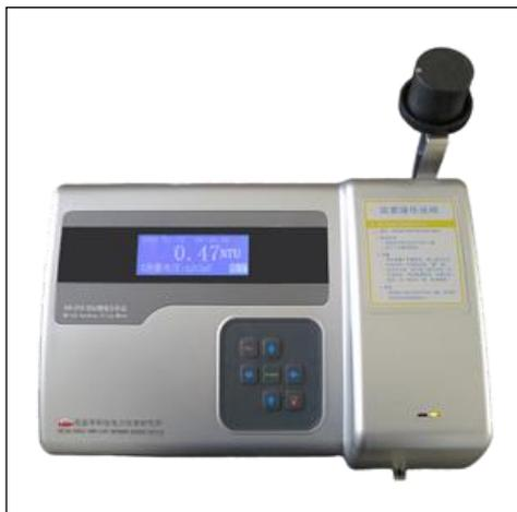
Анализатор фосфатов лабораторный НК-208 предназначен для контроля качества воды электростанций.
