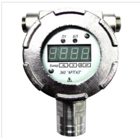
Стационарные газоанализаторы Бинар предназначены для непрерывного автоматического контроля и измерения контролируемого газа в атмосфере, суммы горючих газов, измерения до взрывоопасных концентраций горючих газов и паров горючих жидкостей, в том числе и паров нефтепродуктов, в смеси с воздухом на газо- и нефтепроводах, арматуре газопроводов промышленного и бытового назначения.
