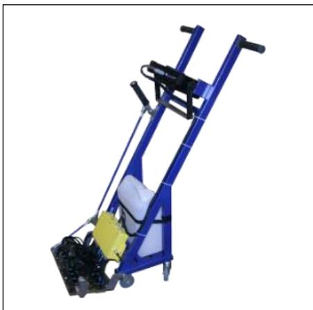
Установка механизированного ультразвукового неразрушающего контроля УКЛ-32 предназначена для проведения ультразвукового контроля качества листового проката различных габаритных размеров, толщиной до 400мм. Контроль проводится при одностороннем доступе к изделию.
