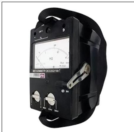
Мегаомметры применяются для измерения сопротивления изоляции электрических проводов, кабелей, разъёмов, трансформаторов, обмоток электрических машин и других устройств, а также для измерения поверхностных и объёмных сопротивлений изоляционных материалов.
