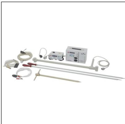
Аппаратура **АНТПИ-3** предназначена для нахождения дефектов изоляции газопроводов, определения трассы металлических подземных газопроводов и спутника неметаллических газопроводов, местонахождения смежных коммуникаций (электрический кабель, водопровод, теплотрасса и др.).
