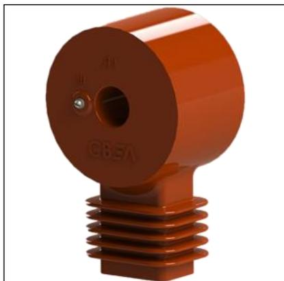
Трансформаторы тока ТШЛ-20 однофазные, по принципу конструкции являются шинными, с литой изоляцией. Первичной обмоткой трансформатора служит шина распределительного устройства, проходящая через внутреннее окно.
