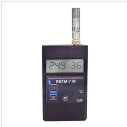
Термогигрометр ИВТМ-7М7-Д предназначен для непрерывного (круглосуточного) измерения и регистрации относительной влажности и температуры воздуха и/или других неагрессивных газов. Может применяться в различных технологических процессах в энергетике, промышленности, сельском хозяйстве, гидрометеорологии и других отраслях хозяйства.
