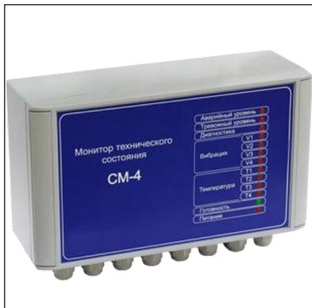
Система мониторинга марки "СМ-4" (Condition Monitoring) предназначена для стационарного контроля и диагностики технического состояния крупных насосов, вентиляторов и дымососов различного назначения. При помощи встроенной в систему функции можно проводить балансировку роторов электродвигателя и вентилятора.
