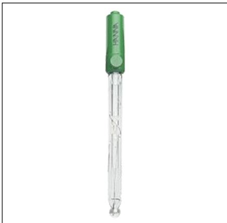
Стекланный заполняемый pH электрод с двойным солевым мостиком и встроенным температурным датчиком для проведения измерений с учетом термокомпенсации. Этот датчик подключается к прибору с помощью 3,5 мм разъема.
