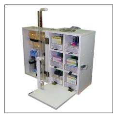
Экспресс-лаборатория ВХЭЛ предназначена для выполнения операционного аналитического химического контроля, предусмотренного при водно-химическом контроле таких котлоагрегатов, как паровые газотрубные котлы, паровые и энерготехнологические котлы и котлы-утилизаторы, водогрейные котлы и т. п.
