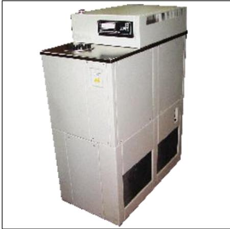
Криостат регулируемый КР-80 предназначен для нагрева и охлаждения датчиков температуры (термопар и термометров сопротивления), ртутных, спиртовых и др. термометров при поверке и градуировке термометров в лабораторных и цеховых условиях. В качестве теплоносителя используется спирт.
