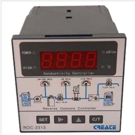
Контроллер-кондуктометр ССТ-7320 следит за работой системы в реальном времени, отображая состояние её компонентов.
