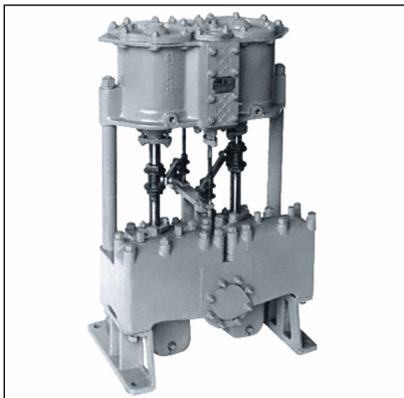
Насосы паровые поршневые предназначены для перекачивания нефти и нефтепродуктов, сжиженных углеводородных газов, морской и пресной воды и других жидкостей, сходных с указанными по плотности, вязкости и химической активности с температурой до 673 К (до 400 °С) в зависимости от исполнения насоса.
