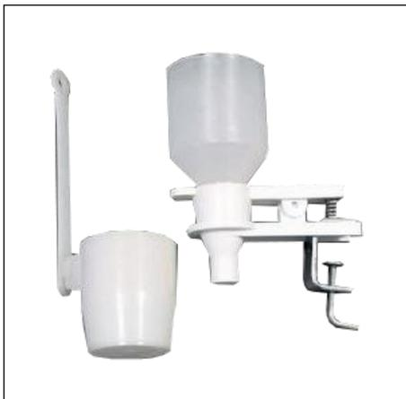
Прибор ОЧМ-М предназначен для определения степени чистоты молока на приемных молочных пунктах, молочнотоварных фермах, маслодельных и сыродельных заводах.
