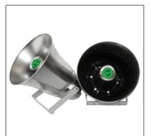
Громкоговоритель рупорный взрывозащищенный **10ГР-38В (240В)** используется в качестве источника звука в системах производственно-технологической громкоговорящей связи, аварийного оповещения и озвучивания во взрывоопасных зонах всех классов кроме зоны О согласно ГОСТ Р51330.9-99 часть 10 и гл. 7.3 ПУЭ, где по условиям работы возможно образование взрывоопасных смесей, отнесенных к категориям IIA, IIB и группам Т1-Т6 по ГОСТ Р51330.11-99 часть 12.
