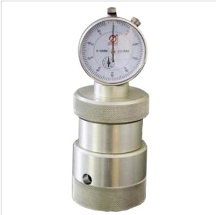
Устройство ПКН-2 предназначено для определения коэффициента набухания глин.
