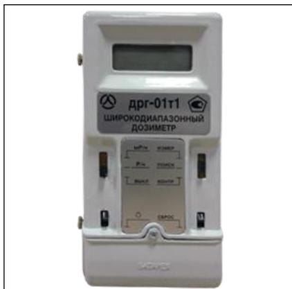
Цифровой широкодиапазонный носимый дозиметр ДРГ-01Т1 предназначен для измерения мощности экспозиционной дозы на рабочих местах, в смежных помещениях и на территории предприятий, использующих радиоактивные вещества и другие источники ионизирующих излучений, в санитарно-защитной зоне и зоне наблюдения.
