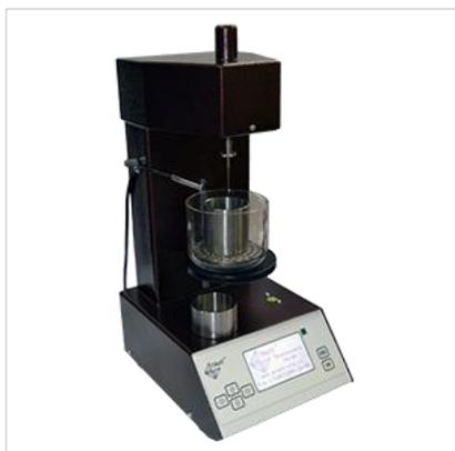
ПН-04 предназначен для определения пенетрации нефтяных битумов и пластичных смазок, а также парафинов и церезинов путем автоматического измерения глубины погружения в испытуемый образец стандартной по массе, форме и размерам иглы (ГОСТ 33136-2014, ГОСТ 11501, ГОСТ 25771) или конуса (ГОСТ 5346) при заданной температуре в течение заданного времени.
