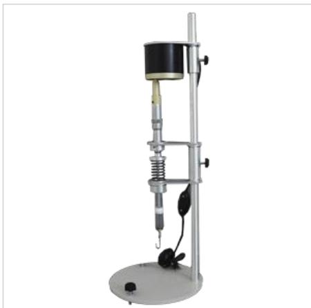
Сталагмометр СТ-2 предназначен для определения поверхностного натяжения растворов ПАВ методом определения объема капель, выдавливаемых на границах: раствор-ПАВ-антиполярная жидкость или раствор ПАВ-воздух.
