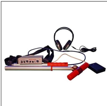
Трассоискатель **ТИ-01М** служит для нахождения трассы и глубины залегания электрических кабелей, которые находятся под напряжением 0,4-10 кВ частотой 50 Гц, а также трубопроводов, которые находятся под напряжением катодной защиты частотой 100 Гц.
