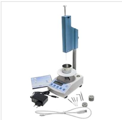
Пенетрометр АПН-360МГ4 предназначен для определения глубины проникания иглы (пенетрации) в испытуемый образец при заданных нагрузке и температуре по ГОСТ 33136 и ГОСТ 11501, в соответствии с МИ2418.
