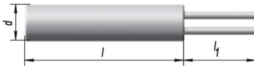
Рис.2 Материал корпуса-нержавеющая сталь, латунь
