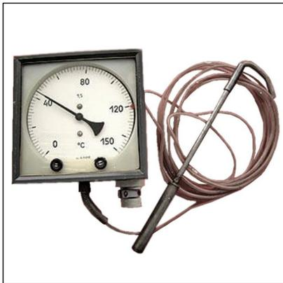
Предназначены для измерения температуры жидких и газообразных сред и коммутации внешних электрических цепей.
