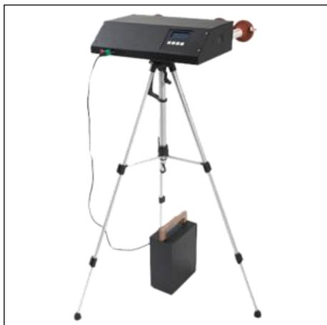
Прибор ПА-300М-1-2 предназначен для отбора разовых проб воздуха рабочей зоны и атмосферы на загрязненность (пыль, газы, аэрозоли).
