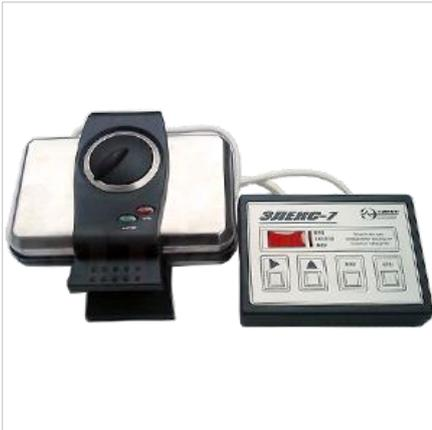
Прибор Элекс-7 предназначен для определения влажности пищевого сырья и продуктов (аналог прибора Чижовой), позволяет выполнять высушивание продуктов при заданной температуре в течение установленного времени. По результатам взвешивания производится расчет влажности. Устройство состоит из блока высушивания и блока управления и контроля.
