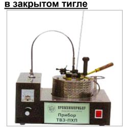
Прибор ТВЗ предназначен для определения температуры вспышки нефтепродуктов, нагреваемых с установленной скоростью в закрытом герметичном тигле.
