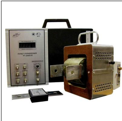
Комплект нагрузочный измерительный с регулятором тока **РТ-2048-06** предназначен для испытания АВ с номинальным током расцепителя от 25 до 400А.
