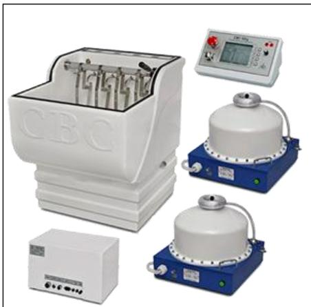
Стенд предназначен для проведения приёмсдаточных и эксплуатационных электрических испытаний средств защиты, используемых в электроустановках. Процесс испытания автоматизирован.
