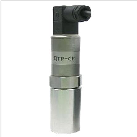
Измерительный преобразователь температуры точки инея ДТР-СМ используется в составе гигрометра ИВА-8 для измерения температуры точки инея воздуха, азота, инертных и других неагрессивных газов, используемых при проведении технологических процессов в электронной, химической, электротехнической промышленности и т.д
