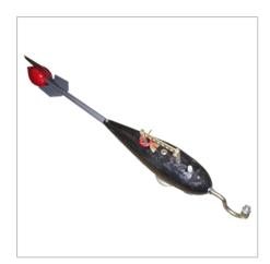
Грузы гидрометрические ПИ-1 с донным и поверхностным контактом, предназначены для производства гидрологических работ на водотоках с большими скоростями.
