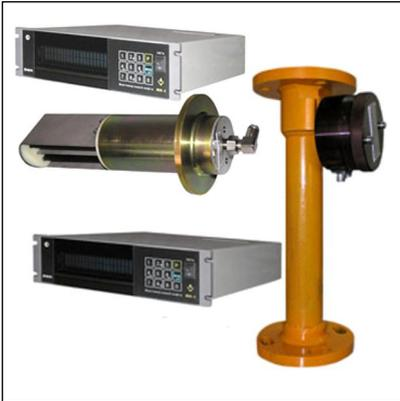
Влагомеры сырой нефти ВСН-2 с диапазонами измерения объемной доли воды от 0 до 100 % предназначены для непрерывного определения содержания воды в нефти после предварительной сепарации свободного газа, вычисления среднего значения объемной доли воды в нефти и объема чистой нефти при работе в комплекте со счетчиком жидкости.
