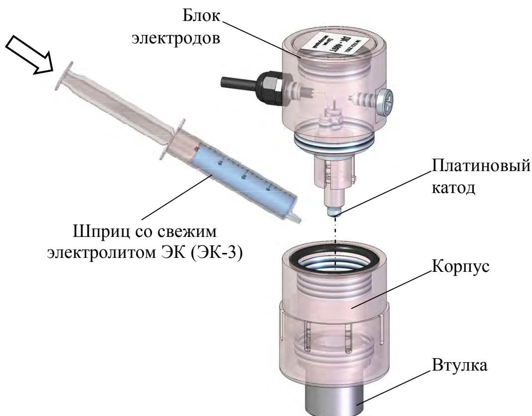
Рисунок 2.6 – Заливка электролита в датчик ДК-409Т, ДК-409ТМ
