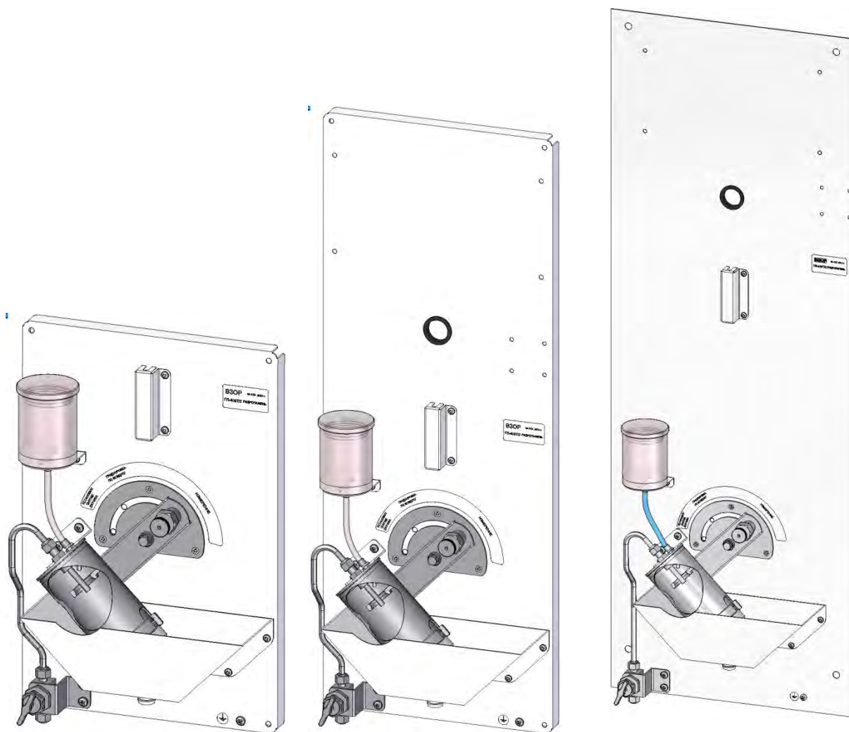
a – Гидропанель ГП-409Т/1
