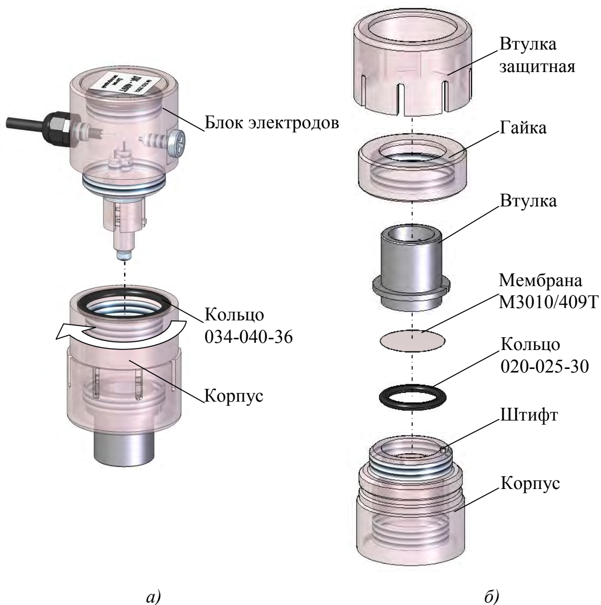
Рисунок 3.1 – Последовательность разборки датчика при замене электролита и мембраны
