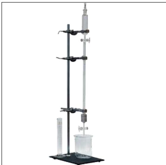
Аппарат УОФТ-01 предназначен для определения коэффициента фильтруемости моторных топлив по ГОСТ 19006-73.
