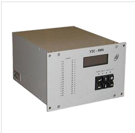
Устройство защиты и сигнализации УЗС-8МА предназначено для предупредительной противоаварийной защиты и сигнализации по 8 (или более) независимым каналам – дискретным и аналоговым (в т. ч. термодатчики, термометры сопротивления, источники тока и напряжения).
