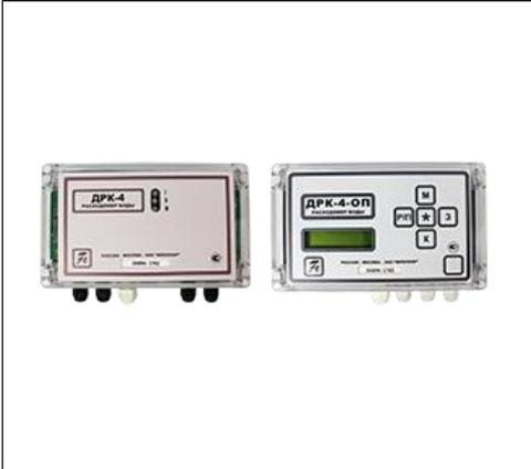
Водомер «ДРК-4» предназначен для измерения объема жидкости, совместим с электронными преобразователями ДРК-ЗЭП (начиная с номера 1700).
